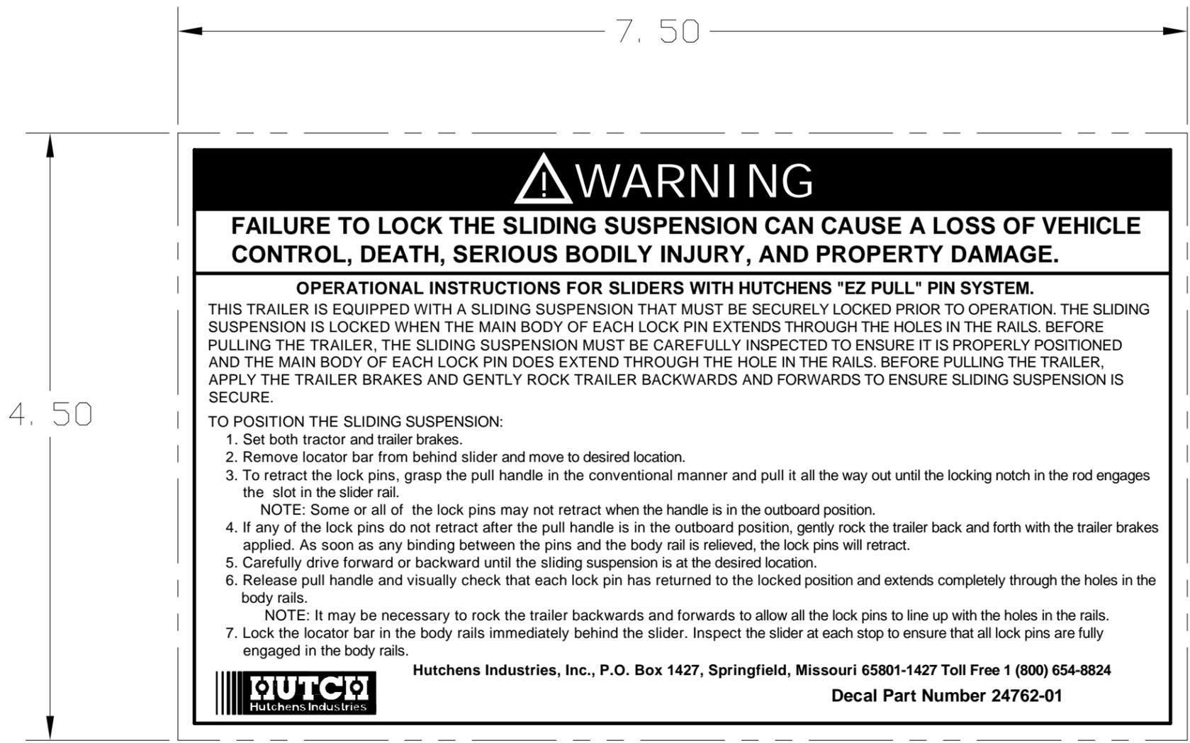
2. PART DESCRIPTION: EZ PULL PIN SYSTEM AND SLIDER OPERATION DECAL.
