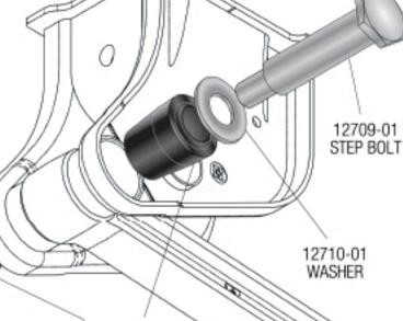
9600 TORQUE ARM CONNECTION COMPONENTS
